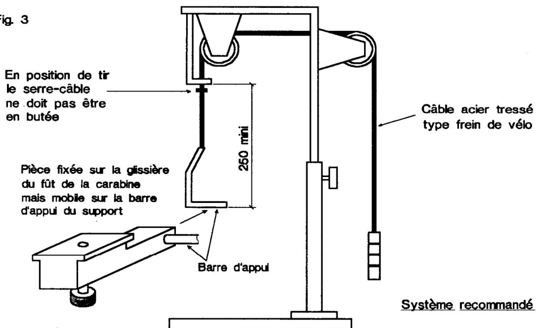
Dans les deux cas, le socle peut être maintenu sur la table de tir à l'aide de serre-joints
